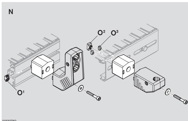
Distanziale - Set (incl. set di fissaggio, ma senza dadi con testa a martello)
