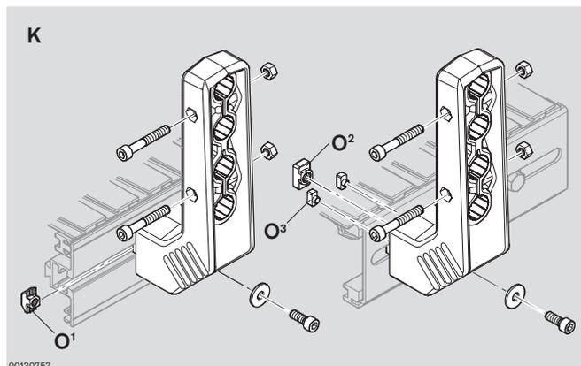
Supporto - Set (incl. set di fissaggio, ma senza dadi con testa a martello)
