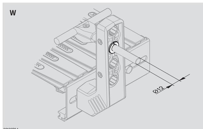
Riduttore  $\varnothing 18/\varnothing 12$
